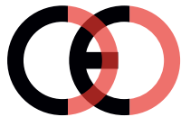
Falsche CE-Kennzeichnung (zu dicht)
