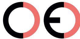
Falsche CE-Kennzeichnung (zu großer Zwischenraum)
